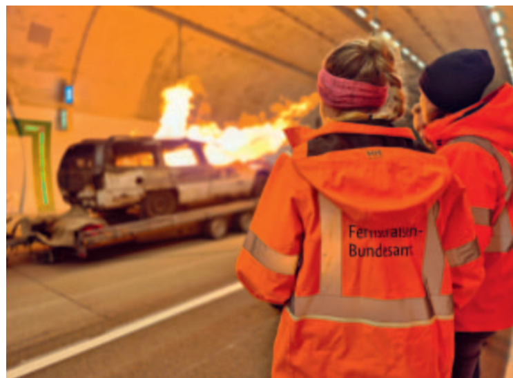
Abb. 5: Brandversuch im Tunnel Boyneburg auf der A 44 (Foto: E. Hartmann)
